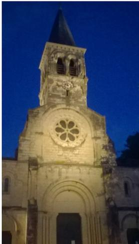
L'éclairage extérieur était constitué de 4 projecteurs: 3 avec sources de 150 watts et 1 avec sources de 400 watts, soit une puissance totale de 850 watts. Ceux-ci ont été déposés et remplacés par 5 projecteurs de 25 watts; 3 projecteurs encastrés de sol de 25 watts viendront compléter cet équipement lors de l'aménagement de la place de la République.
