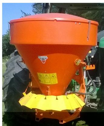
Pour pallier à son remplacement, il a fallu acquérir une saleuse marque ESCOMEL, portée 3 points, capacité 500 litres, cuve synthétique, châssis en acier, groupe d'épandage en inox, entraînement par prise de force, réglage du débit hydraulique.
